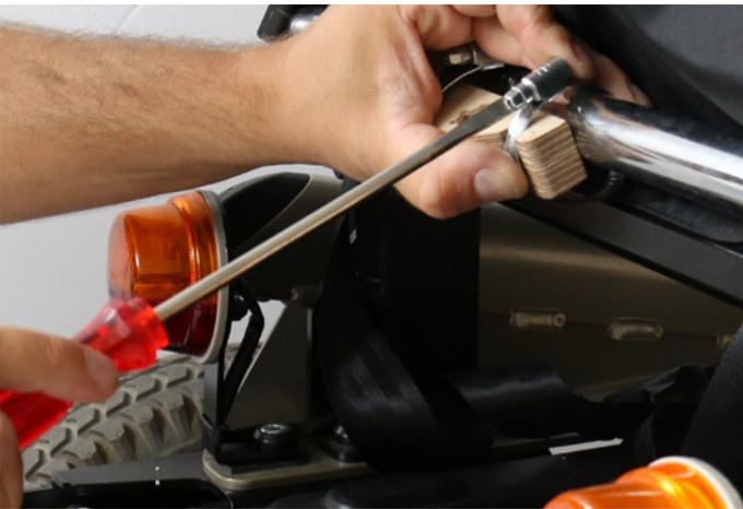
Ziehe die Schrauben der Rohrklammen an. Auch diese Schrauben musst du regelmäßig überprüfen und ggfls. nachziehen.
